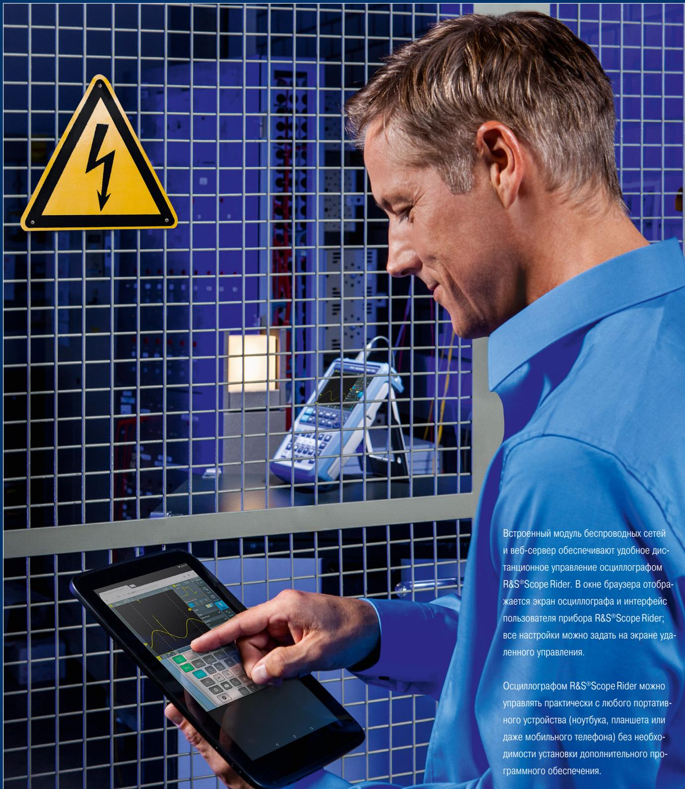
Встроенный модуль беспроводных сетей и веб-сервер обеспечивают удобное дистанционное управление осциллографом R&S®Scope Rider. В окне браузера отображается экран осциллографа и интерфейс пользователя прибора R&S®Scope Rider; все настройки можно задать на экране удаленного управления.
