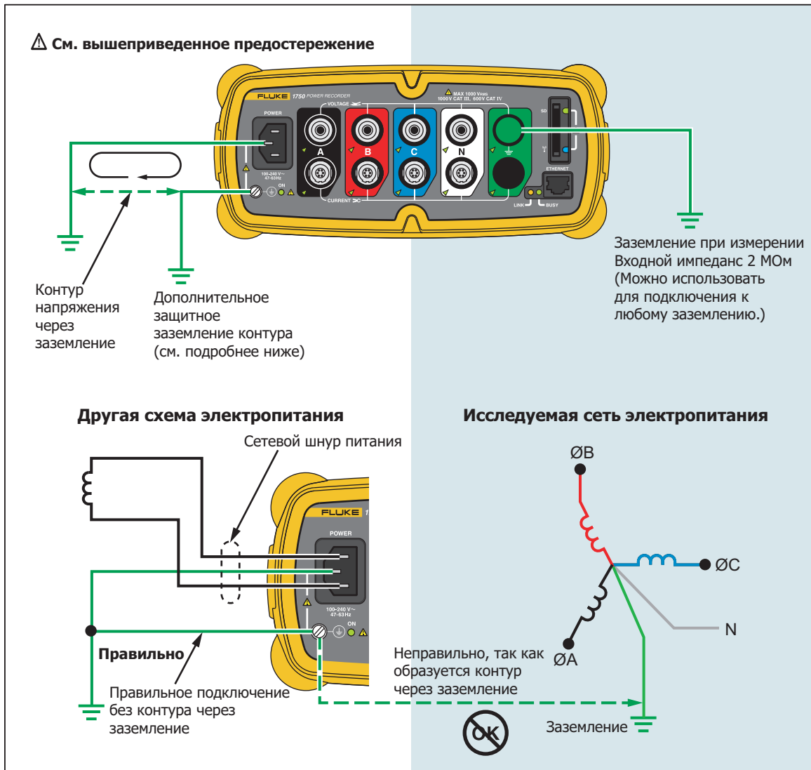
Рис. 3. Подключение дополнительной клеммы заземления
