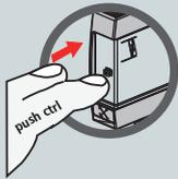
Кнопка нажимается в то время, пока сигнальная лампочка горит оранжевым светом и отпускается по прошествии 5 сек, после того, как светодиодный индикатор гаснет.
