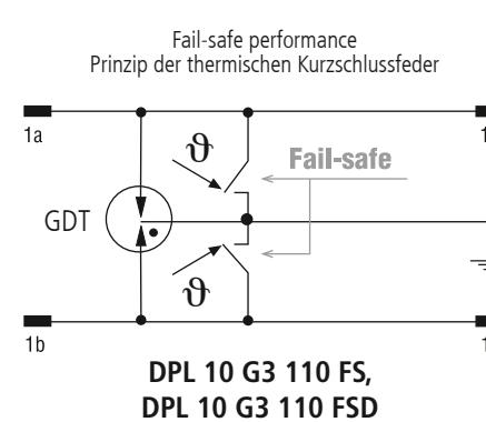
Fig. 5 Test gas discharge tube / Test Gasableiter
