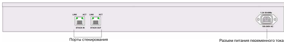
Рисунок 4: Задняя панель AT-8000S/24
