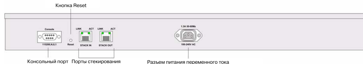
Рисунок 10: Задняя панель AT-8000S/48POE
