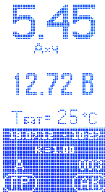
Рис.5. Вид экрана при просмотре записанных измерений.
