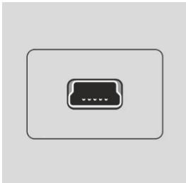
Соединитель для подключения прибора к внешнему управляемому компьютеру.
