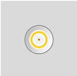
Вход служит для подключения источника сигнала внешнего запуска. Синхронизация или запуск прибора возможен по различным событиям, перечисленным в программном обеспечении.
