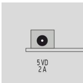
Соединитель предназначен для подключения внешнего блока питания постоянного тока 5 В. В качестве источника питания можно использовать аккумуляторную батарею или бортовую сеть автомобиля через соответствующий кабель питания.
