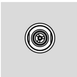
Измерительный порт служит для подключения исследуемого устройства. Измерительный порт выступает как в качестве источника испытательного сигнала, так и в качестве приёмника отраженного сигнала.
