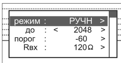
Рисунок 9-16. Меню параметров режима «ШУМ» - ручной режим (при измерении спектра, частота с наибольшим уровнем не отслеживается)
