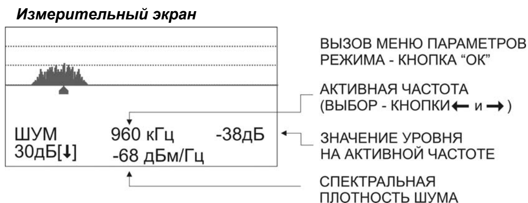
Рисунок 9-15. Экран режима «ШУМ» (на входе приемника сигнал с зашумленной линией)
