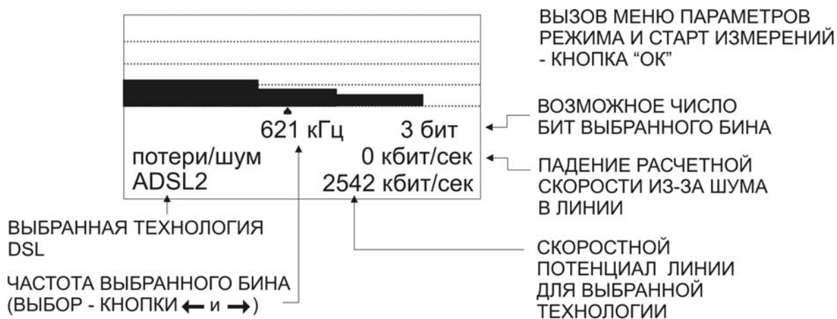
Рисунок 9-26. Вид экрана после проведенного измерения скоростного потенциала линии DSL.
