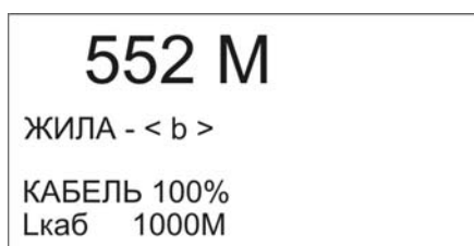
Рисунок 12-5. Экран измерения расстояния до повреждения изоляции
