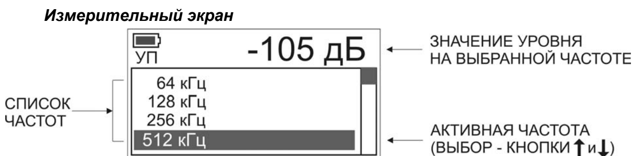
Рисунок 9-13. Экран режима узкополосного измерения уровня
