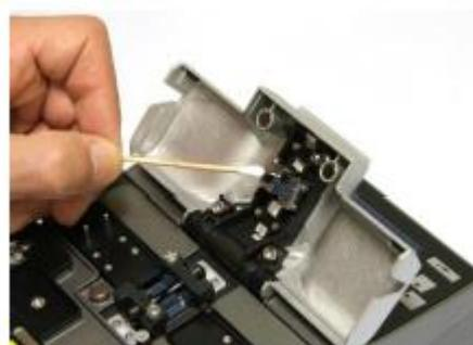
1. Очистите поверхность призмы с помощью очистителя для объективов. Удалите остатки спирта с поверхности призмы чистой и сухой ватой или ватным тампоном.
