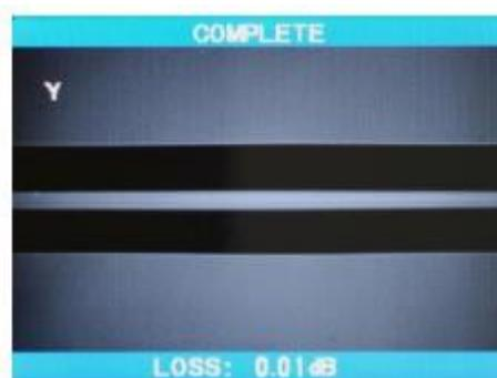
4. После завершения процесса сварки на экране появляется значение измеренных потерь в сварном стыке. На значение потерь влияют элементы ошибки.
