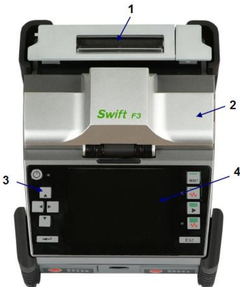
1. Нагреватель защитной трубки
