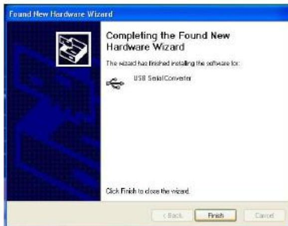
9. По завершении установки драйвера последовательного соединения USB снова запустится мастер обновления оборудования.
