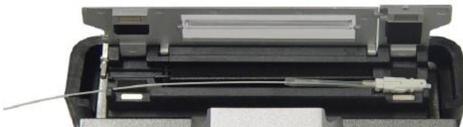
1. 250, 900: Поместите защитную трубку в середину нагревателя и нажмите ее вниз для фиксации. Закройте крышку нагревателя.
