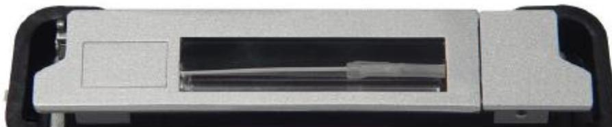
2. При помещении защитной трубки с волокном в нагреватель прижмите волокно вниз, чтобы крышка нагревателя закрылась автоматически.
