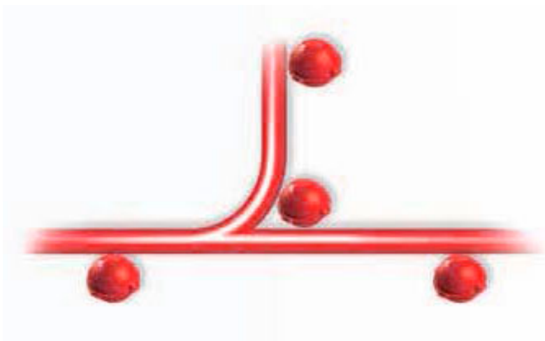
Рисунок 5 – Маркировка ответвлений кабельных трасс
