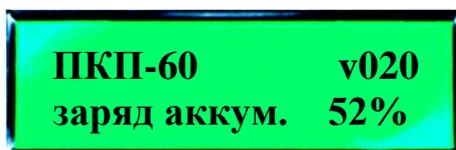
В верхней строке указана модификация исполнения прибора, в нижней – уровень зарядки аккумуляторов (цифра приблизительная, зависящая от степени износа аккумуляторов). Состояние прибора, при котором на дисплей выведена эта надпись, называется ниже «*исходным*».
