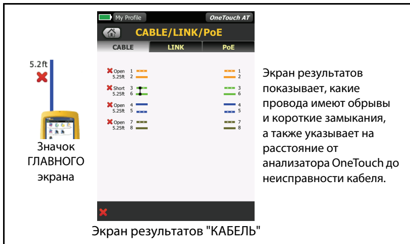
Рис. 29. Кабель без разъемов, имеющий короткие замыкания и обрывы На рисунке показан экран анализатора при подключении кабеля без разъемов, имеющего короткие замыкания и обрывы, к порту А.
