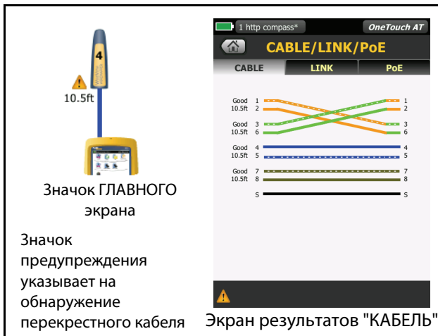
Рис. 27. Экранированный перекрестный кабель подключен к WireMapper № 4
