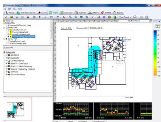
Рисунок 10: Просмотр радиочастотных помех и их источников
