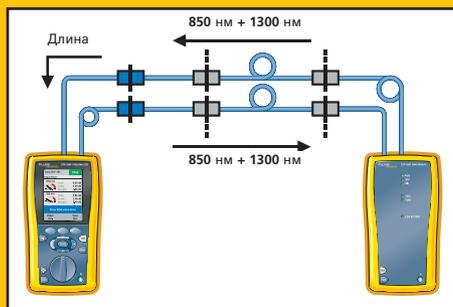
В отличие от оптических адаптеров других производителей, которые измеряют длину и делают два измерения оптических потерь за «Автотест», DTX – единственное решение для тестирования оптического кабеля, которое измеряет длину кабеля и делает четыре измерения оптических потерь за «Автотест» – и все за 12 секунд. С помощью оптических DTX модулей вы можете выполнить тестирование в пять раз быстрее других производителей.
