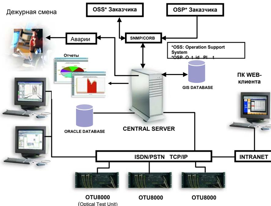
Выбор требуемого модуля OTDR для OTU8000 определяется минимально необходимым расстоянием контролируемого участка ВОСЛ. Для расчета можно применять формулу:
