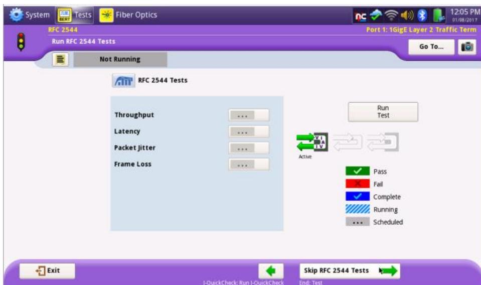
По завершении тестов, заворот на дальнем конце будет автоматически отключен (при использовании активного устройства). Статус Pass/Fail для каждого теста обозначается или . Тесты без выставленных порогов отмечаются как . Тест потеря пакетов всегда отмечается , так как не имеет порогов. Подробные данные по каждому тесту можно посмотреть, нажав на .
