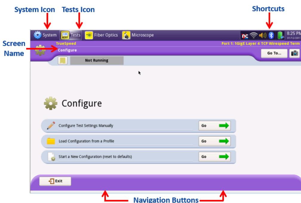
Нажмите клавишу в разделе “Configure Test Settings Manually.”
