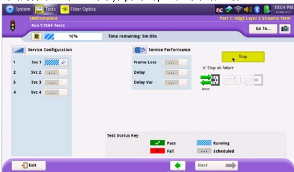
По завершении тестов, заворот на дальнем конце будет автоматически отключен (при использовании активного устройства). Статус Pass/Fail для каждого теста обозначается или . Тесты без выставленных порогов отмечаются как . Подробные данные по каждому тесту можно посмотреть нажав на .
