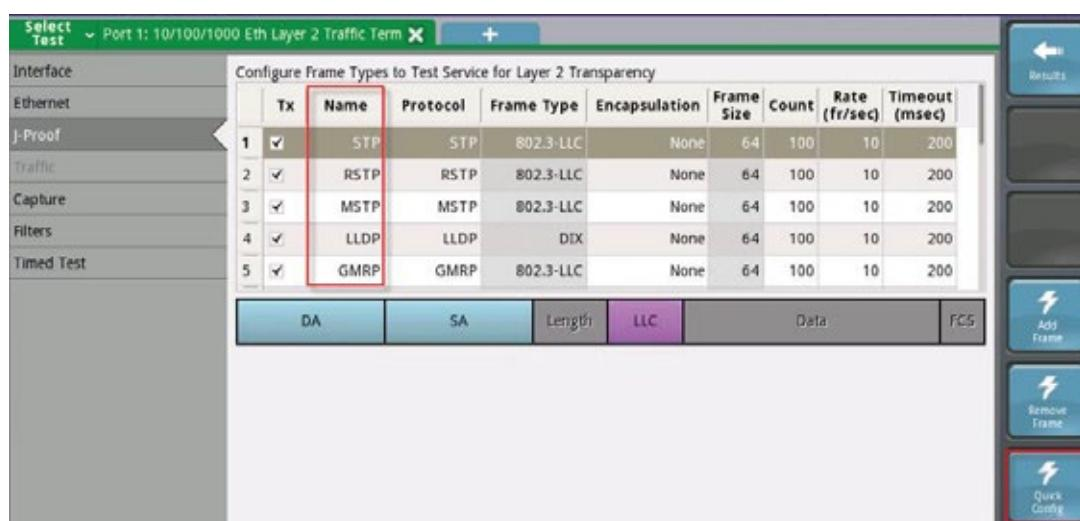
Нажав кнопку Quick config в правом нижнем углу анализатор автоматически сформирует набор из 5 (из 20 возможных вариантов) протоколов управления.
