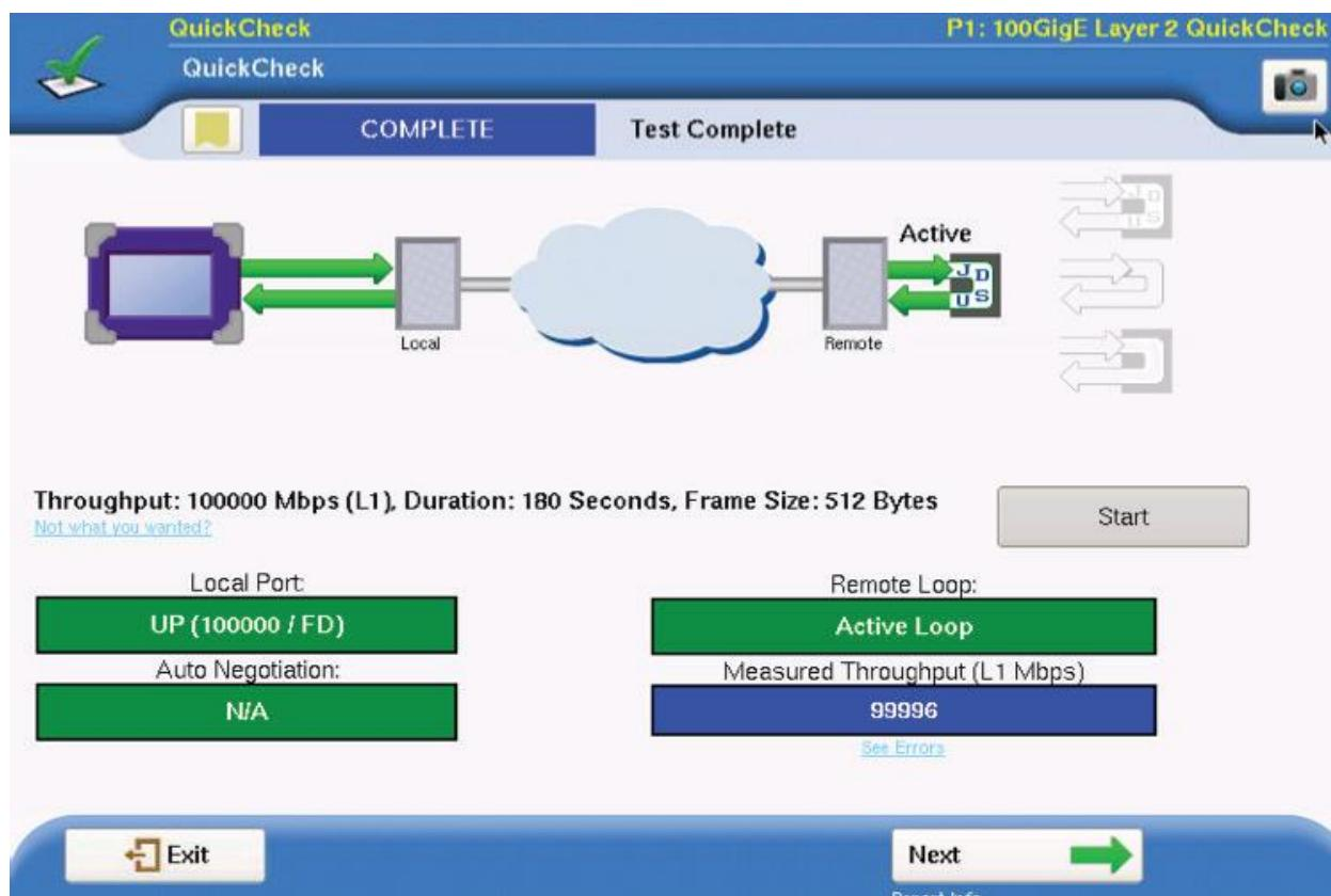
После нажатия кнопки START прибор автоматически определит согласование, скорость и пропускную способность канала.
