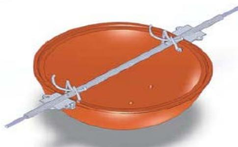
(4) Соедините верхнюю полусферу с нижней полусферой. Чтобы гребень правильной вошел в паз, пожалуйста, совмещайте кабельные зажимы с напечатанным одинаковым номером (например, номером «2») на одной стороне каждой половины сферы.
