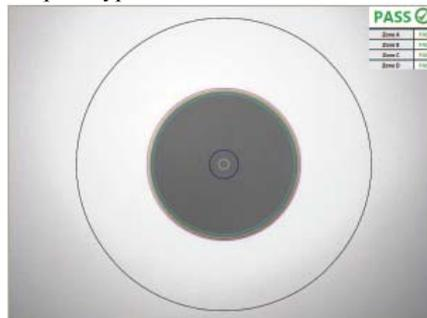
**Определяемые пользователем критерии приемки PASS/FAIL**
