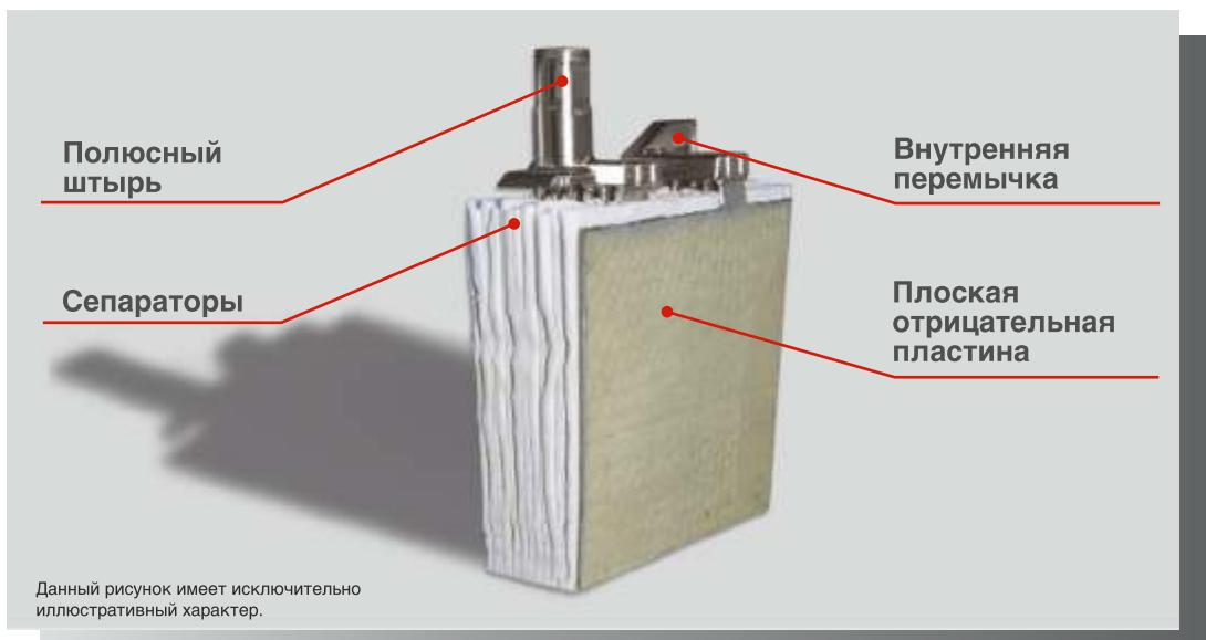
В АККУМУЛЯТОРАХ FIAMM FGL ПРИМЕНЯЕТСЯ ТЕХНОЛОГИЯ AGM (ABSORBED GLASS MAT – ПОРИСТЫЙ ЗАПОЛНИТЕЛЬ ИЗ СТЕКЛОВОЛОКНА). ЭЛЕКТРОЛИТ ПОЛНОСТЬЮ ВПИТЫВАЕТСЯ В СТЕКЛОВОЛОКОННЫЙ СЕПАРАТОР, ЭФФЕКТИВНОСТЬ РЕКОМБИНАЦИИ ГАЗОВ СОСТАВЛЯЕТ 99%. БЛОКИ ОТЛИЧАЮТСЯ ПРОЧНОСТЬЮ, ГЕРМЕТИЧНОСТЬЮ И НЕ ТРЕБУЮТ ДОЛИВКИ ЭЛЕКТРОЛИТА В ТЕЧЕНИЕ ВСЕГО СРОКА СЛУЖБЫ. НИЗКИЙ УРОВЕНЬ САМОРАЗРЯДА ПОЗВОЛЯЕТ ХРАНИТЬ БАТАРЕИ БЕЗ ЗАРЯДКИ ДО 6 МЕСЯЦЕВ.
