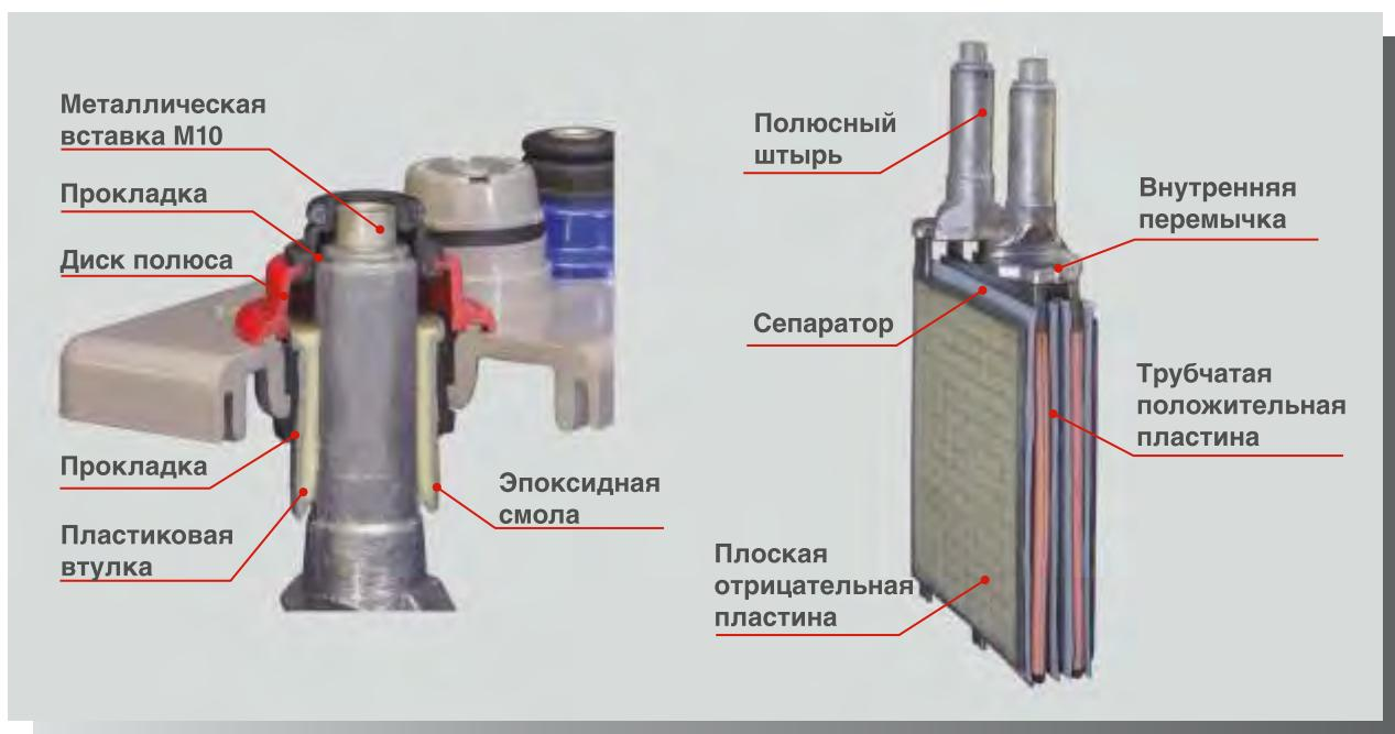
УНИКАЛЬНАЯ КОНСТРУКЦИЯ КЛЕММ FIAMM НА ЭЛЕМЕНТАХ 2 В ПРЕДОТВРАЩАЕТ ОБРАЗОВАНИЕ УТЕЧЕК ПРИ ОБРАСТАНИИ ШТЫРЯ. ДАННОЕ ПРИСПОСОБЛЕНИЕ ПРЕДОХРАНЯЕТ КРЫШКУ БАТАРЕИ ОТ МЕХАНИЧЕСКИХ НАГРУЗОК.
