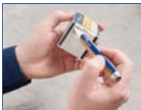
Достав из куба чистый платочек нанесите небольшое количество растворителя на начальный угол платочка.
