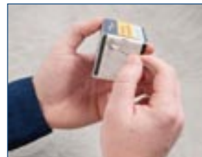
Прикоснитесь тампоном к пятну растворителя на платочке и подержите его в таком положении 3 сек, чтобы он впитал минимальное количество растворителя. Лучше использовать слегка смоченный тампон, чем сильно намоченный. Если наносить растворитель на тампон непосредственно с помощью растворяющего карандаша, тампон будет содержать слишком большое количество растворителя.
