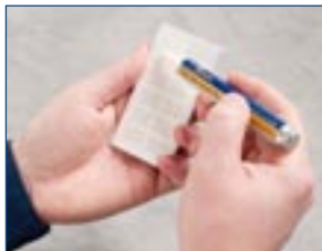
После снятия одной пластмассовой крышки нанесите небольшое количество растворителя на начальный угол чистящей зоны.
