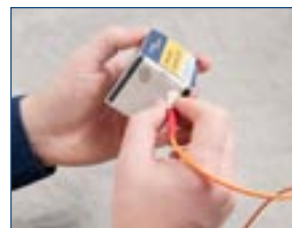
Удерживая соединитель в перпендикулярном положении, переместите его торцевую поверхность в сухую зону.
