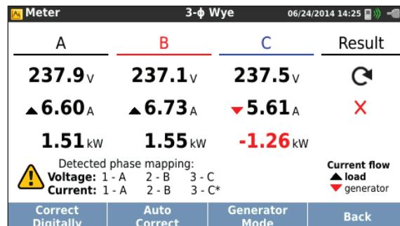
Интеллектуальная функция проверки позволяет цифровым способом скорректировать наиболее распространенные измерительные соединения
