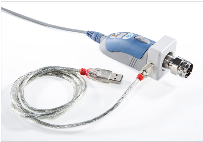
Адаптер R&S®RT-ZA9 N-типа (вилка) для активных широкополосных пробников для использования с анализаторами спектра и сигналами.
