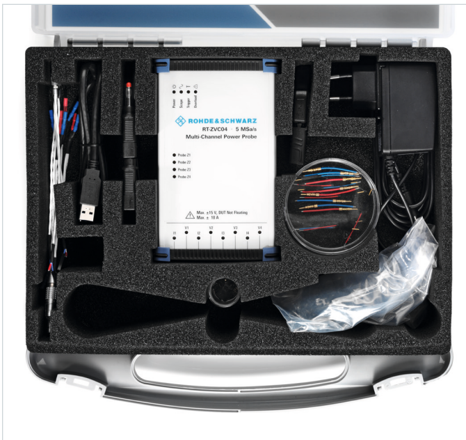
К стандартным принадлежностям относятся кабели для подключения к печатным платам для каждого канала и впаиваемые провода.
