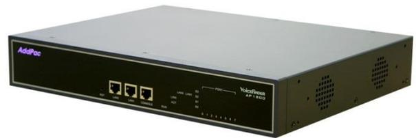
VoIP-шлюз AddPac AP1800 представляет из себя шасси со встроенным блоком питания и модулем процессора.
